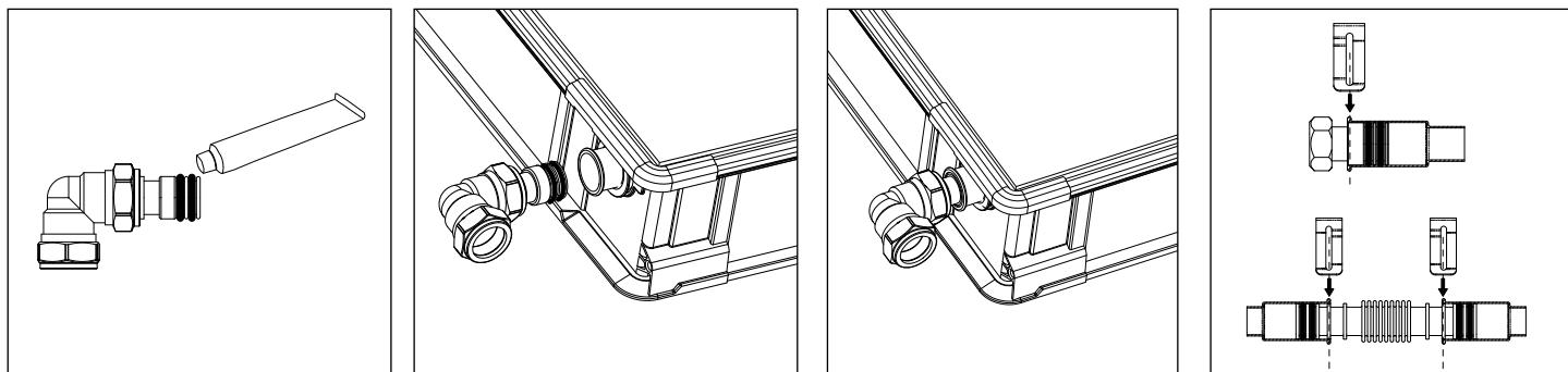
Bloquear la unión con la pinza de fijación. Introducir el tubo (liso, de 22 mm) en la unión, luego apretar. Proceder entonces con el aislamiento de las tuberías y las uniones.
