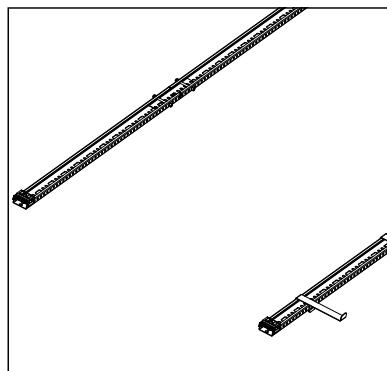
Appoggiare il collettore sulle barre orizzontali e posizionare il profilo del collettore fino a portarlo a toccare con la parte in plastica delle staffe.
