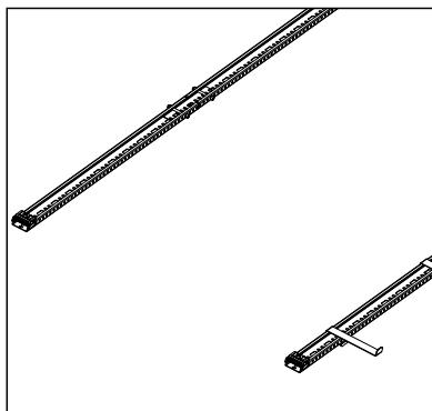
Apoyar el colector sobre las barras horizontales y colocar el perfil del colector de manera que llegue a tocar la parte plástica de los estribos. Controlar que el perfil inferior del colector quede apoyado sobre las barras antideslizamiento. ATENCIÓN: Los colectores tienen que montarse de manera que los registros para la sonda de temperatura queden en la parte superior izquierda. Apretar el tornillo para bloquear el panel. Repetir el procedimiento con los cuatro estribos de bloqueo.
