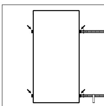
Si fuera necesario montar otro colector, colocar otra grapa de enganche adicional en cada barra horizontal dejándola en contacto con la instalada anteriormente y repetir las mismas operaciones efectuadas para el primer colector. Engrasar las empaquetaduras de anillo a ambos lados de los compensadores usando el producto específico.
