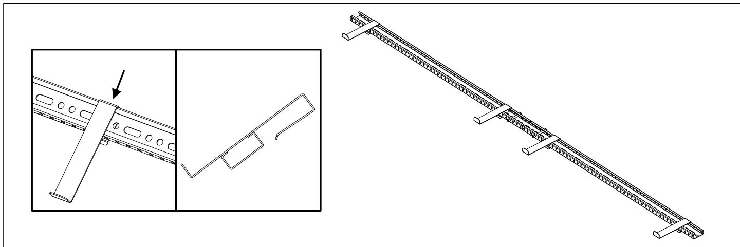
Verificare il parallelismo delle barre superiore ed inferiore (A) e l'allineamento misurando che le diagonali siano identiche (B).
