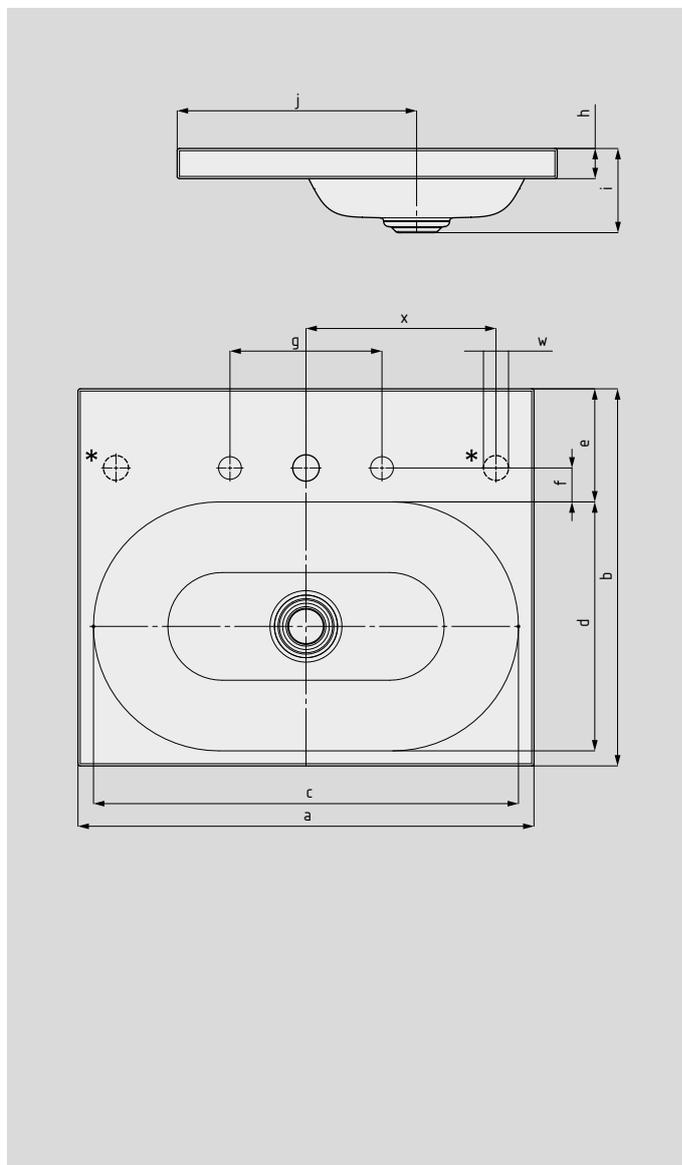
\* Foro della manopola per scarico e sistema di troppopieno CLOU con apertura dello scarico azionata a cavo e manopola montata sul bordo, con opzione a sinistra o destra
