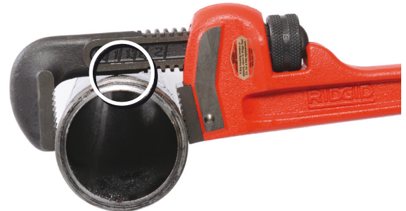
Figuur 4 – Tang te klein voor het werkstuk: haakschacht raakt het werkstuk.
