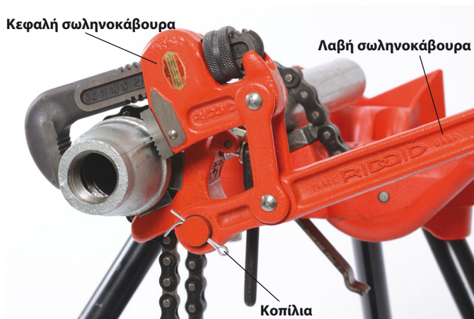
Εικόνα 6Β – Στερέωση λαβής στο δίσχο
