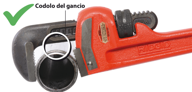
Figura 3 – Mantenere uno spazio tra il codolo del gancio e il pezzo in lavorazione
