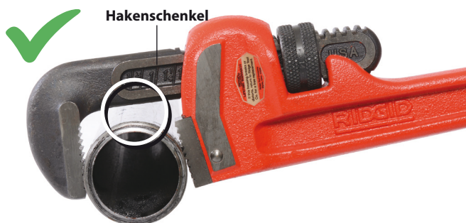
Abbildung 3 – Spalt zwischen Hakenschenkel und Werkstück lassen
