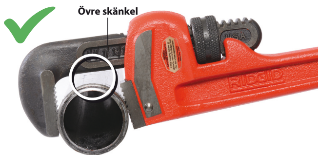
Figur 3 – Behåll avståndet mellan den övre skänkeln och arbetsstycket
