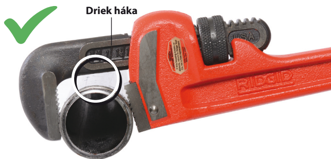
Obrázok 3 – Zachovávať medzeru medzi drikom háka a obrobkom
