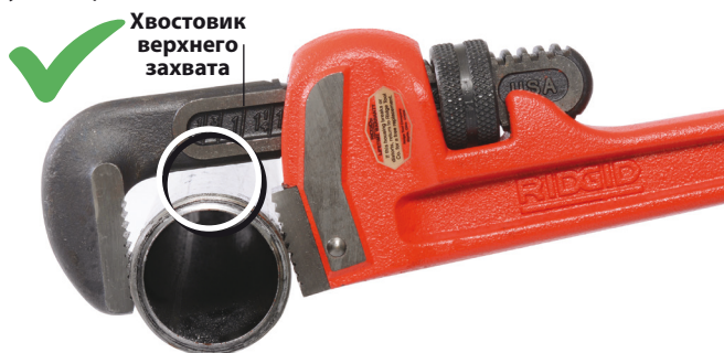
Рис. 3 – Зазор между хвостовиком верхнего захвата и изделием
