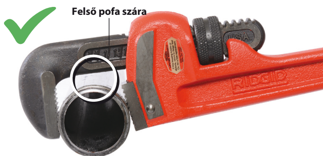
3. ábra – Tartson hézagot a felső pofa szára és a munkadarab között
