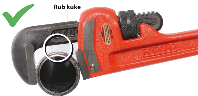
Slika 3 - Održavajte razmak između ruba kuke i radnog dijela
