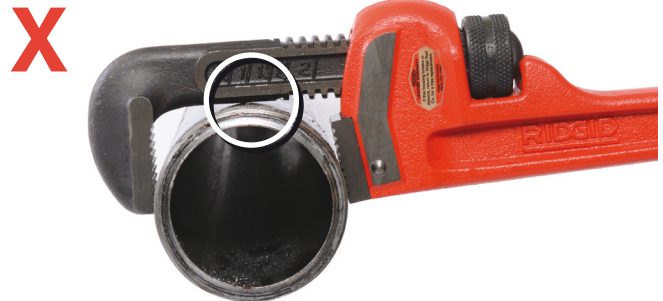
Slika 4 - Kliješta su premala za radni dio, rub kuke dodiruje radni dio.
