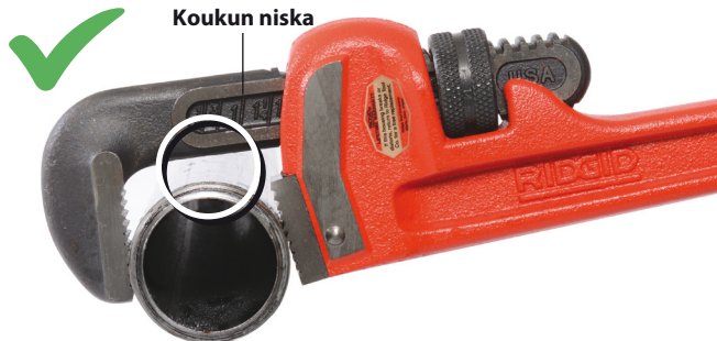
Kuva 3 – Pidä väli koukun niskan ja työkalupaleen välillä
