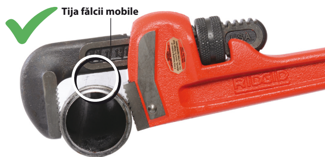
Figura 3 – Mențineți intervalul între tija fâlcii mobile și piesa de prelucrat
