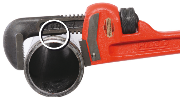
Εικόνα 4 – Πολύ μικρός σωληνοκάβουρας για το αντικείμενο εργασίας, το στέλεχος κινητής σιαγόνας αγγίζει το αντικείμενο.
