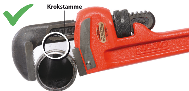
Figur 3 – Oppretthold mellomrommet mellom krokstammen og arbeidsemnet
