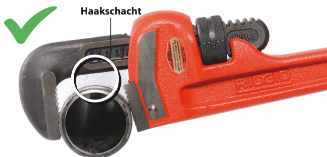
Figuur 3 – Houdt altijd speling tussen de schacht van de haakse bek en het werkstuk
