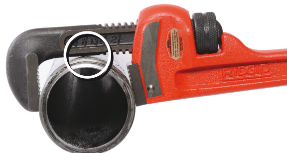
Figura 4 - Chave demasiado pequena para a peça de trabalho, haste do gancho a tocar na peça de trabalho.
