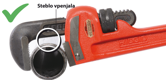
Slika 3 - Ohranite razmik med stebлом vpenjala in obdelovancem
