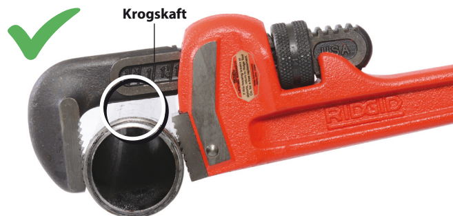
Figur 3 – Bibeholdelse af afstand mellem krogskæft og arbejdssemne
