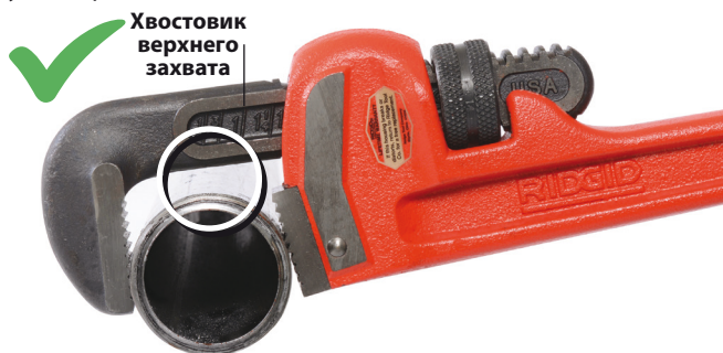
Рис. 3 – Зазор между хвостовиком верхнего захвата и изделием
