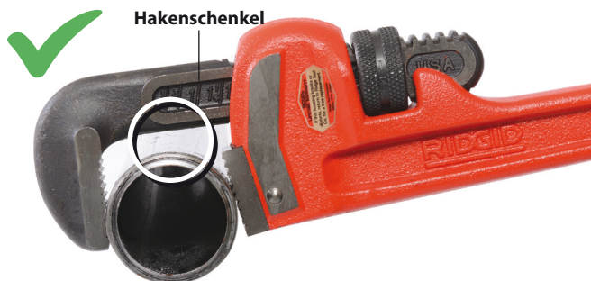
Abbildung 3 – Spalt zwischen Hakenschenkel und Werkstück lassen
