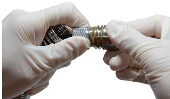
**Figura 23 – Rimuovere la testa della telecamera**
