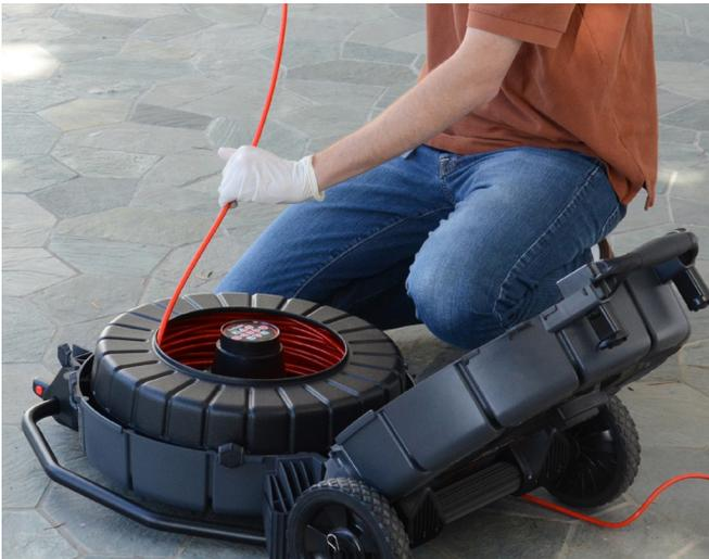
**Figure 27 – Come guidare il cavo di spinta dentro il tamburo**
