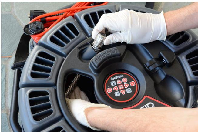
**Figure 28 – Sistemazione della testa della telecamera**
