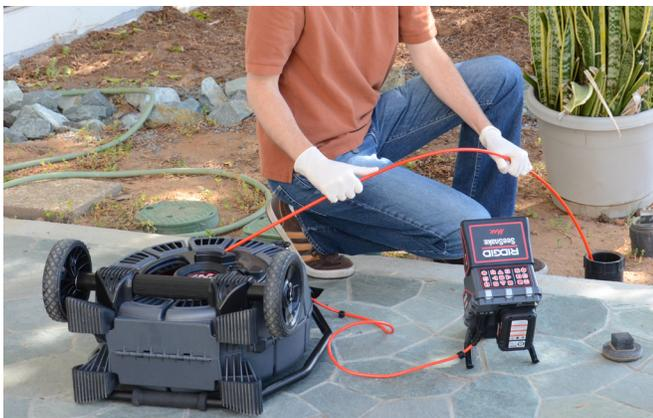
Figura 15 – rM200 in posizione orizzontale con la parte posteriore a terra
