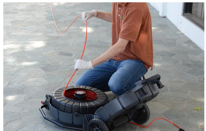
Figura 26 – Come girare il tamburo per riavvolgere il cavo di spinta in modo corretto
