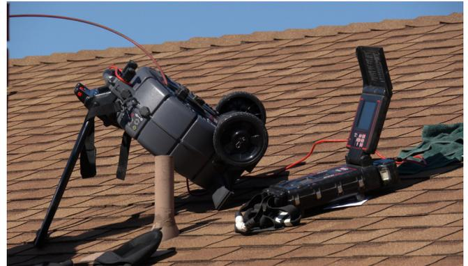
Figura 16 – rM200 col suo cavalletto durante un'ispezione su un tetto
