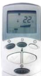
2. Accendere il condizionatore e impostare la temperatura a 22° C e la ventilazione su velocità intermedia.
