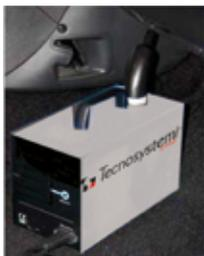
1. Avviare il motore del veicolo e appoggiare *Ultrasonic Clean Machine* sulla moquette lato passeggero e avvicinare il tubo convogliatore all'apertura d'aspirazione del ricircolo d'aria.
