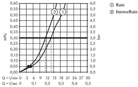
I valori di consumo sono stati misurati nella pratica con le armature appartenenti (Termostato/Miscelatore/Valvola sotto-intonaco).
