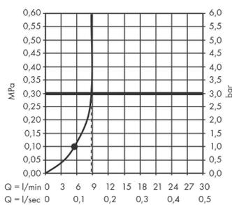
I valori di consumo sono stati misurati nella pratica con le armature appartenenti (Termostato/Miscelatore/Valvola sotto-intonaco).
