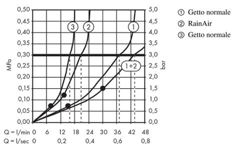
I valori di consumo sono stati misurati nella pratica con le armature appartenenti (Termostato/Miscelatore/Valvola sotto-intonaco).
