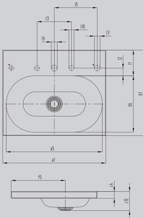
\*Fori per la manopola della valvola di scarico e troppopieno CLOU con cavo e manopola a scelta destra o a sinistra
