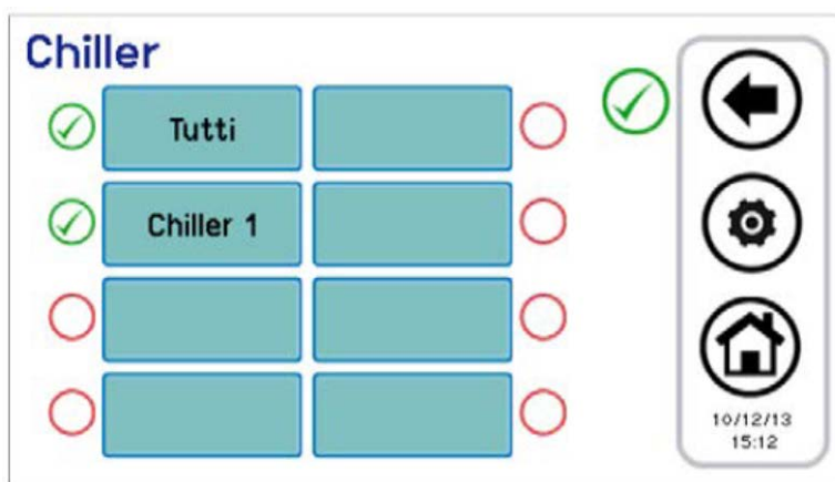
Figura 23. Scelta chiller/pompe di calore per produzione ACS
