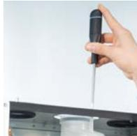
Rimozione vite blocco
