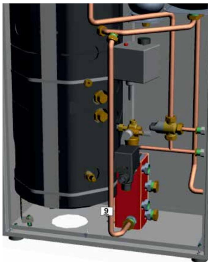
Inserire il compensatore e collegare il tubo **9** (coibentato)
