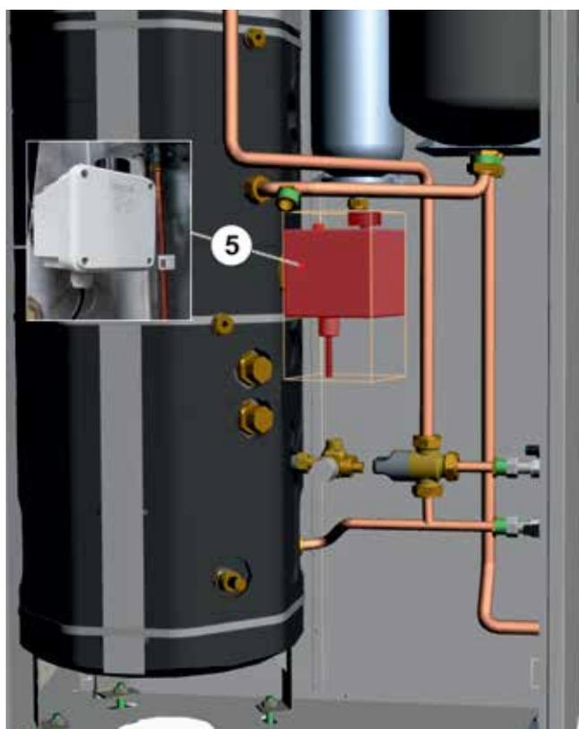
Inserire resistenza di integrazione **5** (Fissare con teflon, canapa, pasta idraulica)
