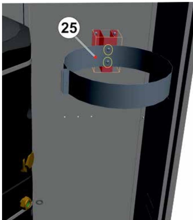
Fissare lamiera vaso solare **25** alla staffa **21**
