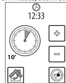
Na displeji se zobrazuje čas zbývající do ukončení vodní masáže a označené tlačítko 9 znamená, že je vodní masáž zapnuta.
