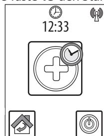
Die Pumpe setzt sich in Betrieb und nach kurzer Zeit gelangt das Desinfektionsmittel in den Kreislauf. Nach 4 Minuten hält die Pumpe an und startet dann wieder für eine Minute.
