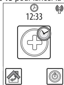
La pompe se met en marche et en l'espace de quelques secondes, le désinfectant est introduit dans le circuit. Au bout de 4 minutes, la pompe s'arrête pendant environ 20 minutes, puis redémarre pour une durée de 1 minute.
