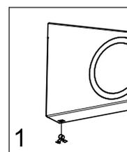
Inserire le 4 clips di fissaggio copertura nelle apposite asole;
