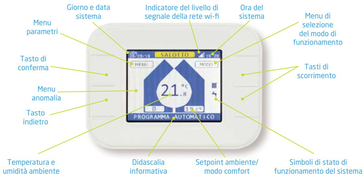
Il pannello di controllo remoto per installazione a parete è dotato di un ampio text display a colori e retroilluminazione, 4 tasti di selezione menù. Le principali funzioni sono:
