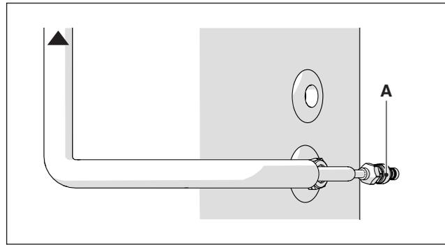
**!** Se si sono utilizzate delle tubazioni in rame e si è eseguita una brasatura forte è necessario lavare l'impianto dai residui del fondente di brasatura. Successivamente eseguire la prova di tenuta.
