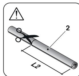
Rimuovere la pellicola adesiva (5) e applicare i due isolamenti (1-2) sulle tubazioni, con la giunzione posizionata nella parte posteriore.
