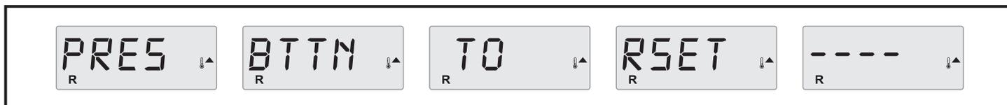
Figure 36: schéma de message de réinitialisation
