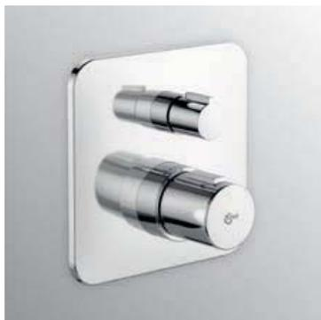
Miscelatore termostatico ad incasso individuale per doccia. Comando regolazione portata acqua con resistenza per la limitazione del flusso idrico al 50%. Lavora con corpo incasso Easy Box A1000NU, da ordinare separatamente. Il codice è comprensivo di parti esterne, cartuccia termostatica.
