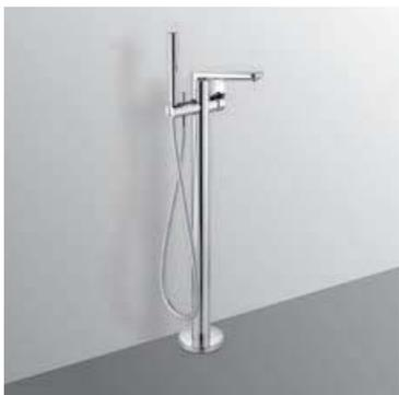
Gruppo miscelatore da appoggio per vasca centro stanza. Costituito da miscelatore monocomando con bocca d'erogazione fissa e doccetta minimale con flessibile Idealflex 1250 mm. Supporto doccetta e deviatore integrati. Piastra per fissaggio a terra compresa. Lavora con incasso a pavimento A6133NU da ordinare separatamente.
