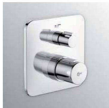
Miscelatore termostatico ad incasso individuale con deviatore per vasca/doccia. Comando regolazione portata acqua con resistenza per la limitazione del flusso idrico al 50% (per entrambe le uscite). Lavora con corpo incasso Easy Box A1000NU, da ordinare separatamente. Il codice è comprensivo di parti esterne, cartuccia termostatica e deviatore.
